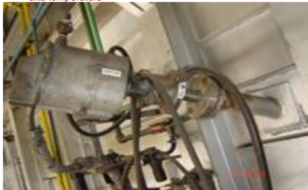
Cámara de horno HD. Carcasa refrigerada por agua de alta temperatura
